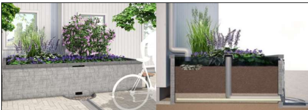
Figur 27. Principskiss på upphöjt biofilter som tar emot dagvatten från tak via stuprör (Lindfors, Bodin-Sköld, & Larm, 2014).
